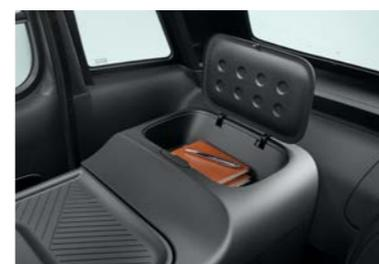
Modulable et escamotable, la tablette peut être relevée soit vers le conducteur pour une meilleure accessibilité à la zone de stockage depuis l'extérieur, soit vers la porte passager afin d'atteindre facilement le contenu depuis le siège conducteur.
