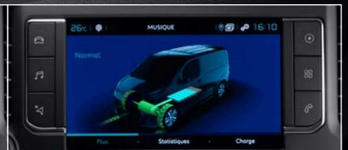
**FLUX D'ÉNERGIE** : permet de visualiser le fonctionnement de la technologie électrique.
